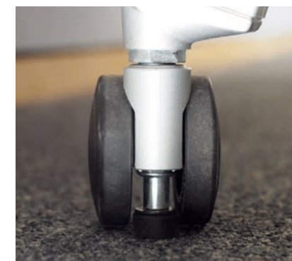
STANDFEST: Ein „Stempel“ der sich beim Herunterklappen der Tischplatte automatisch ausfährt, verriegelt die Tischbeine – der Tisch kann nicht wegrollen.
